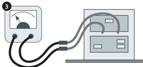
Des tensions et des courants élevés sont présents au niveau du condensateur haute tension. Il est très dangereux de travailler à proximité de ce composant lorsque le four est allumé. Ne mesurez JAMAIS la tension au niveau des circuits haute tension, y compris le filament du magnétron.
