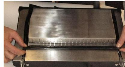
6. Aplique sellante debajo de la junta de la puerta y presione con firmeza hacia abajo para fijar la junta en la puerta. Asegúrese de que está recta y retire cualquier exceso de sellante.
