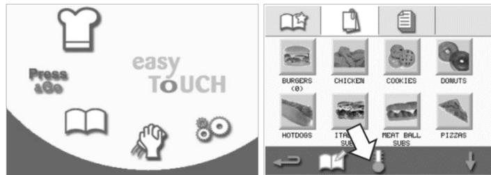
2. En la pantalla de temperatura, seleccione el símbolo del termómetro azul para deshabilitar el calentamiento y comenzar el ciclo de enfriamiento.
