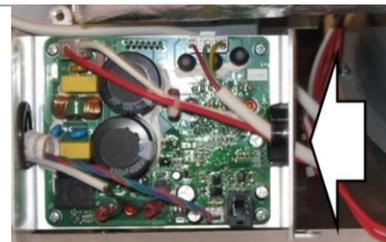
4. Desenchufe las conexiones de los microinterruptores de la puerta a la izquierda del aparato.
