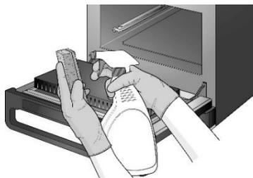
5. Para las zonas difíciles, deje actuar durante 10 minutos con la puerta del aparato abierta. Utilice un estropajo de nailon no abrasivo.
