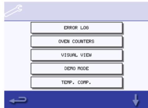
2. Entre los detalles se incluye el número de toques en la pantalla, los ciclos del filtro, los ciclos de la puerta, los encendidos totales del horno, el encendido a tiempo del magnetrón y el elemento del calentador y la temperatura ambiente del área de los controles en el armario.
