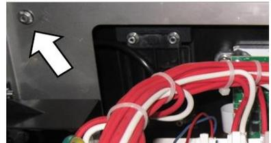
3. Retire el panel delantero superior (incluida la pantalla táctil y el conjunto de PTR) del bastidor de la carcasa, levantándolo hacia arriba y hacia la parte delantera del aparato. Observe los tres tacos en las esquinas del conjunto que fijan el conjunto al cuerpo del aparato.
