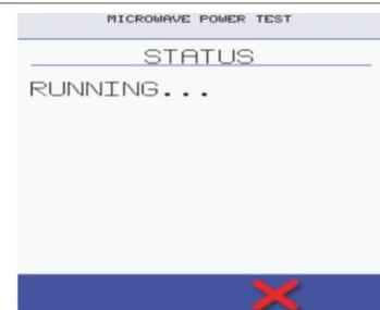
6. Una vez acabada la cuenta atrás, retire el recipiente de la cavidad. Remueva inmediatamente el agua con un utensilio de plástico y mida la temperatura del agua.
