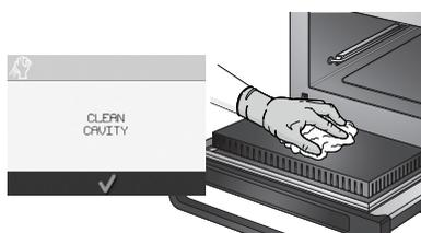
7. Seque o forno e suas partes com o auxílio de um pano limpo. Pressione o tique na tela "Clean cavity" (Limpeza da cavidade) para continuar.
