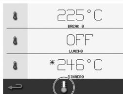
2. Dans l'écran de température, sélectionner le symbole du thermomètre bleu pour désactiver le chauffage et démarrer le cycle de refroidissement.
