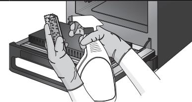
4. Tragen Sie einen von Merrychef zugelassenen Reiniger auf einen Schwamm auf und reinigen Sie alle Innenflächen des Geräts, **mit Ausnahme der Deckplatte (Düsenplatte) und der Türdichtung**.
