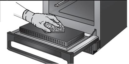
5. Bei schwierigen Stellen 10 Minuten lang bei geöffneter Gerätetür einwirken lassen und dann mit einem nicht scheuernden Nylon-Schwamm reinigen.
