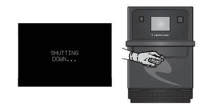
10. Das Gerät schaltet sich nun ab. Wischen Sie das Gerät von außen mit einem feuchten Tuch ab.
