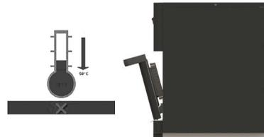
3. Der Abkühlungsfortschritt wird angezeigt. Um die Abkühlzeit zu verkürzen, halten Sie die Gerätetür leicht geöffnet.
