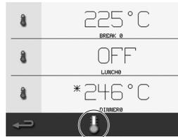
2. Wählen Sie in der Temperaturanzeige das Symbol „blaues Thermometer“, um die Heizung zu deaktivieren und den Kühlbetrieb zu starten.
