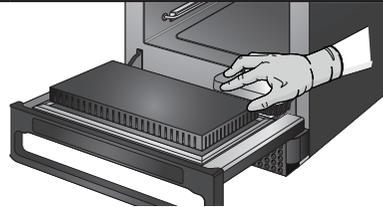
3. Verwenden Sie einen trockenen, sauberen Pinsel/eine Bürste, um Essensreste zwischen dem Garraumboden und der Innenseite der Gerätetür zu entfernen.
