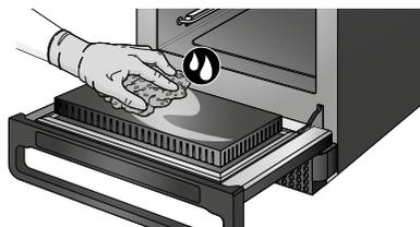
6. Протрите все поверхности влажной чистой тканью. Верхнюю поверхность полости печи и уплотнитель дверцы также можно протереть, если необходимо удалить остатки пищевых продуктов, но эти детали печи не нуждаются в регулярной очистке.
