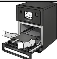
1. Откройте дверцу устройства и выньте из полости печи подставку для приготовления, а также любые другие принадлежности, используемые для приготовления.
