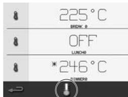
2. На экране температуры нажмите значок «синий термометр» для отключения нагрева и запуска цикла охлаждения.
