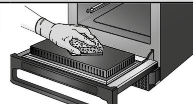
5. Оставьте для отмокания зоны, где очистка затруднена, на 10 минут с открытой дверцей устройства, и затем используйте неабразивную нейлоновую чистящую губку.
