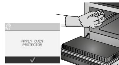
8. Нанесите защитное химическое покрытие для печи (опционально) Распределите защитное химическое покрытие тонким слоем по всем внутренним поверхностям с помощью губки, избегая попадания его на верхнюю поверхность полости печи и уплотнитель дверцы. Для продолжения нажмите галочку на экране.
