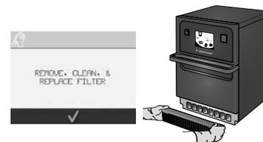
9. Поставьте на место подставку для приготовления и закройте дверцу. Извлеките воздушный фильтр и протрите его начисто или промойте в мыльной воде. Просушите его и установите на место, затем нажмите галочку на экране для продолжения.
